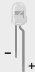
Eine LED kann über Pins gesteuert werden und benötigt ein *digitales* Signal (0 oder 1). Hierbei ist der Baustein
