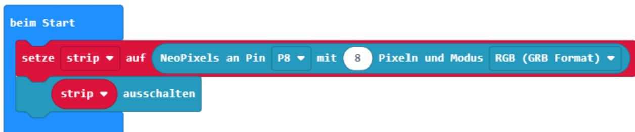
Hier wird die Länge des Strips (bei uns 8) und der Pin festgelegt.
